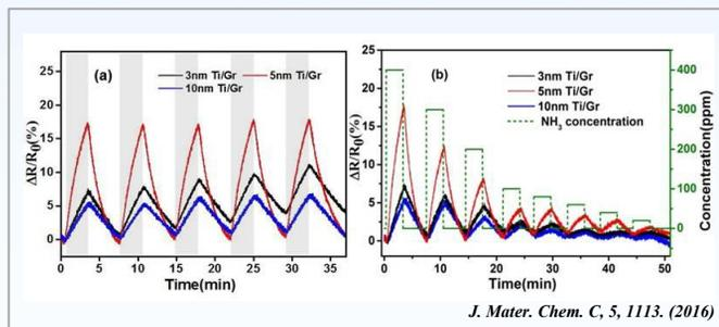
常温可见光照射下石墨烯传感器对氨气探测灵敏度的提高
