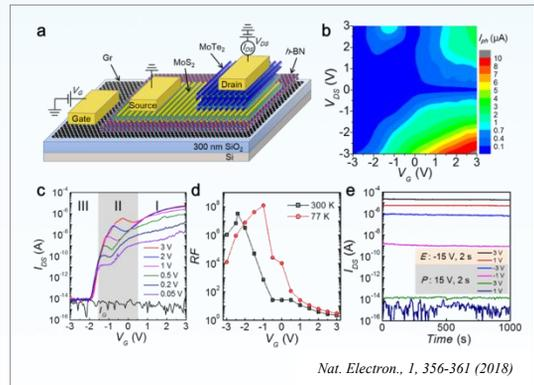
非对称范德华异质结器件结构示意图与电输运/光电特性
