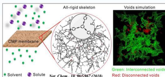
共轭微孔聚合物全共轭的骨架结构提供了高的骨架刚性，从而导致薄膜具有丰富的微孔及优异的内部连通性
